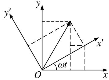
$$\mathbf{F}' = -m\omega_0^2\mathbf{r} - e\mathbf{v} \times \mathbf{B} - m\boldsymbol{\omega} \times (\boldsymbol{\omega} \times \mathbf{r}) - 2m\boldsymbol{\omega} \times \mathbf{v}' \quad (1)$$
