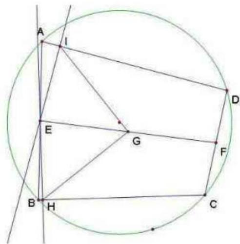
首先可这样转化图形：作 E 点关于 AD、BC 边的轴对称点 S、T，显然 I、H 分别是 ES、ET 中点。由中位线，可将原题转化为证：FS=FT。再延长 AD、BC 相交于 P 点。由 A、B、C、D 是圆内接四边形。知 $\triangle PCD \sim \triangle PAB$ ，而 PF、PE 分别是这两个三角形的对应中线，故 $\angle DPF = \angle BPE$ ；这就表明 E 和 F 是 $\angle APB$  内的两个“等角点”（即指满足左、右两角相等）。
