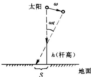
地球自西朝东自转相当于太阳自东朝西绕地球转动, 地球  $24 \times 60 \times 60\text{s}$  自转一周, 故太阳  $24 \times 60 \times 60\text{s}$  绕地球转动一周 太阳绕地球转动的角速度为:
