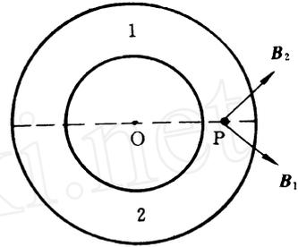
电容器中无论传导电流或位移电流都是沿径向的, 只是两者方向相反 (如果电容器一直与电源相连, 则由于电场稳定, 无位移电流). 由于电流分布的球对称性 可知如有磁场其分布亦必是球对称的
